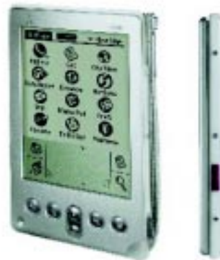
รูปที่ 2 : Handsprint Visor Edge ใช้พอร์ต IrDA (สี่เหลี่ยมสีแดง) ในการสื่อสารกับ PDA ตัวอื่น หรือใช้ในการปรับหรือซิงค์ข้อมูลให้ตรงกันกับเครื่องพีซี
