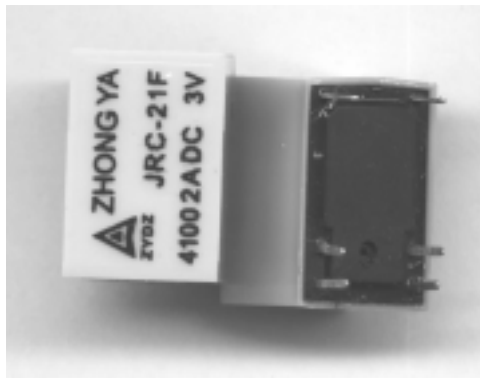
รูปที่ 5 : ภาพของรีเลย์ตัวจิ๋วที่ใช้ในรคต้นแบบ
