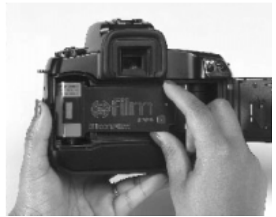
รูปที่ 2 : Silicon Film Technologies ออกแบบให้ อี-ฟิล์มใส่ลงในกล้อง SLR 35 มม.
