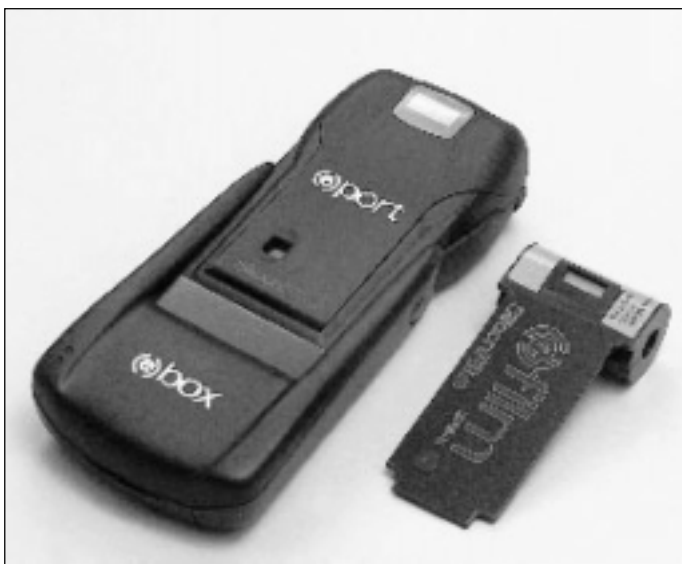
รูปที่ 1 : ระบบ EFS-1 ประกอบด้วยอี-ฟิล์มสำหรับการจับภาพ อี-พอร์ดสำหรับการถ่ายข้อมูลภาพไปยังพีซี และ อี-บ็อกซ์สำหรับใช้เป็นที่เก็บข้อมูลภาพขนาดใหญ่ชั่วคราว
