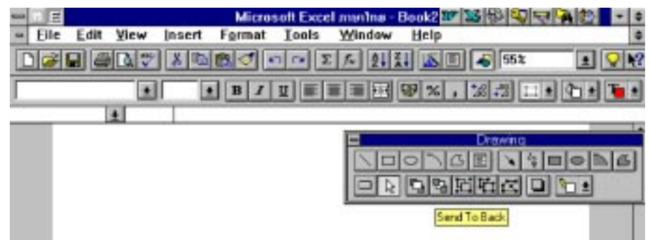
รูปที่ 4 : แสดงตำแหน่งของปุ่มคำสั่ง Send to Back ใน Drawing Toolbar เพื่อใช้ในการสั่งให้ภาพที่ต้องไปซ่อนอยู่ทางด้านหลังของภาพอื่น
