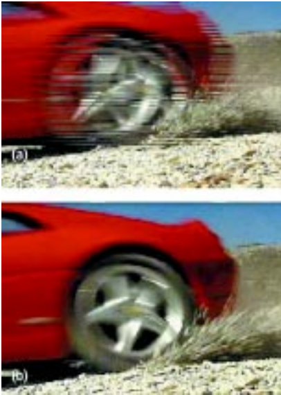
รูปที่ 3 : การเปรียบเทียบเมื่อจับภาพหยุดนิ่ง จากรูป (a) จะเห็นความยืดหยุ่นของภาพโดยอาศัยการแก้ไขสัญญาณแบบ telecining ผลที่ได้จะเป็นแบบรูป (b)
