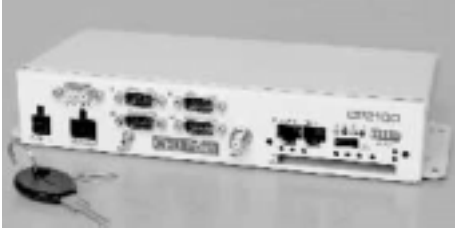
ราคาของ CP2100 Mobile Network Server ของ CellPort Labs อยู่ที่ $995 ที่ประกอบด้วยระบบ Interface เข้ากับระบบเครือข่ายของรถยนต์ เช่น CAN และ J1850 และ Interface ของระบบสัญญาณไร้สายเช่น โทรศัพท์มือถือ เพจเจอร์ และ อุปกรณ์สื่อสารอื่นๆ
