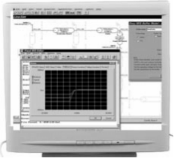
รูปที่ 1 : ซอฟต์แวร์ HyperLynx's IBIS ที่ใช้สำหรับพัฒนาระบบ ซึ่งซอฟต์แวร์ตัวนี้จะมีชุดเครื่องมือหรือ tools ในการสร้าง, จำลองการทำงาน (simulate) และดูโมเดลที่เกี่ยวกับ performance ของระบบที่เราสร้างขึ้นผ่านทาง IBIS-model performance.
