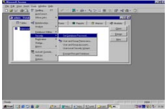
รูปที่ 15 : วิธีการตั้งรหัสผ่านสำหรับฐานข้อมูลของ Microsoft Access
